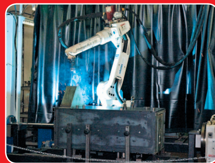
Robotizované svařovací CNC pracoviště
